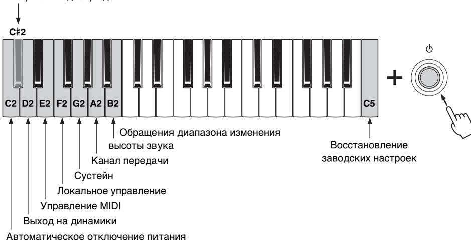
На устройстве reface DX эти настройки могут быть выполнены с помощью кнопки [FUNCTION]. Подробнее см. в разделе «Функции компонентов передней панели», посвященном устройству reface DX (стр. 16).
