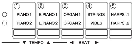
Выберите два тембра и одновременно нажмите соответствующие кнопки тембра. Для выхода из режима наложения нажмите любую кнопку тембра. В режиме наложения тембр с более низким номером группы будет считаться тембром 1, а с более высоким — тембром 2 (см. иллюстрацию). Невозможно наложить два тембра, входящие в одну группу.
