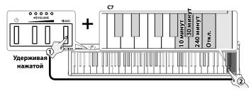
Настройки функции автоматического отключения питания
